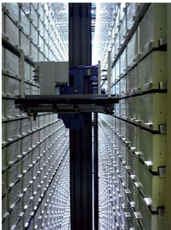
Obr. 12 Regálový zakladač v automatizovaném skladu knihovny (vlevo) 42 , řešení přenesené ze systému „Miniload“ pro výškové sklady drobného kusového materiálu (vpravo). 43
