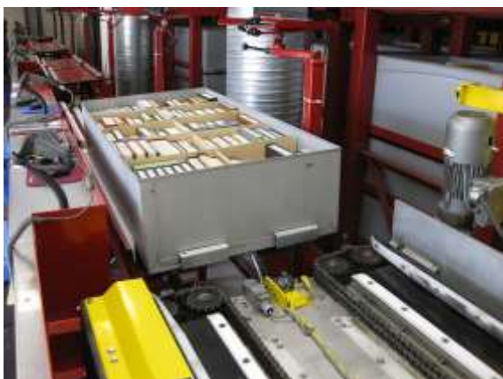
Obr. 13 Manipulace s ukládacími bednami na místě výdeje z automatizovaného zakladačového skladu knihovny Macquarie University v Austrálii 44
